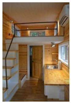
Aprovechando la altura de los techos, en este monoambiente se construyó un entrepiso sobre las áreas del baño y la cocina, al cual se accede mediante una escalera metálica.
