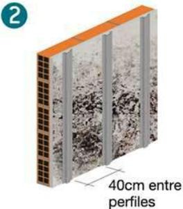
Fijar los perfiles Omega sobre el muro a revestir cada 40 cm. Utilizar tarugos N°8 y sus tornillos correspondientes separados cada 60cm sobre las alas.
