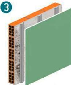
Colocar las placas sobre los perfiles Omega en forma vertical. Fijar las placas con tronillos T2 a la perfilera. No sellar el perímetro con Promaseal A en este sistema.
