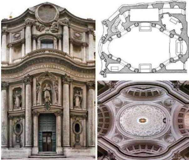
Las edificaciones barrocas poseen diversos centros o ejes constructivos según la complejidad del diseño. En lugar de restringirse a figuras con un único eje central, como el círculo, el cuadrado y la cruz griega, crean un efecto policéntrico mediante otras figuras o mediante nuevas combinaciones de las figuras mencionadas. Se prefiere el uso de plantas elípticas, combinando líneas curvas y rectas. Se usan formas de la naturaleza para la proyección de plantas inusuales.
